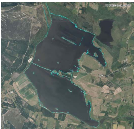
Foto 1. Luftfoto af den nye Filsø med sydbassinet med hovedtilløbet i sydøst og nordbassinet med udløbet i nordvest. En dæmning skiller de to bassiner. Foto COWI.
